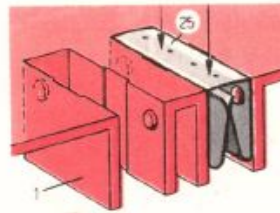
Bild 6. Einsetzen der Steckfedern
