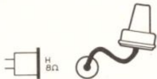
Bild 79. Schaltzeichen und Aufbaudarstellung des Ohrhörers
