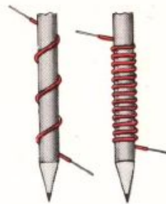
Bild 15. Drähte zu Spiralen drehen
