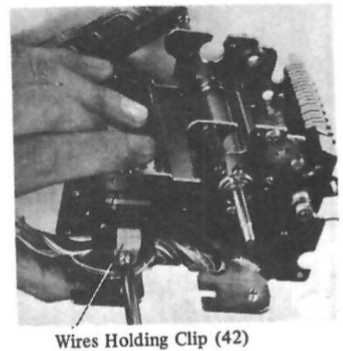
Fig. 8-49 Kabelbaum befestigen
