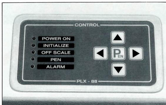
Selbstverständlich verfügt der PLX-88 über den hochentwickelten und weltweit verbreiteten HP-GL Standard und ist dadurch einfach zu programmieren. Er ist mit dem Plotter 7475A von Hewlett-Packard kompatibel.
